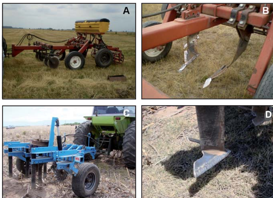
Figura 2. Sembradoras para la intersemebra de forrajeras con púas montadas para realizar descompactación (A y B) y equipo descompactador desarrollado por el INTA San Luis (C y D).
