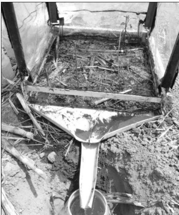
Figura 4. Detalle de la parcela del micro-simulador de lluvias con salida de escurrimientos.
