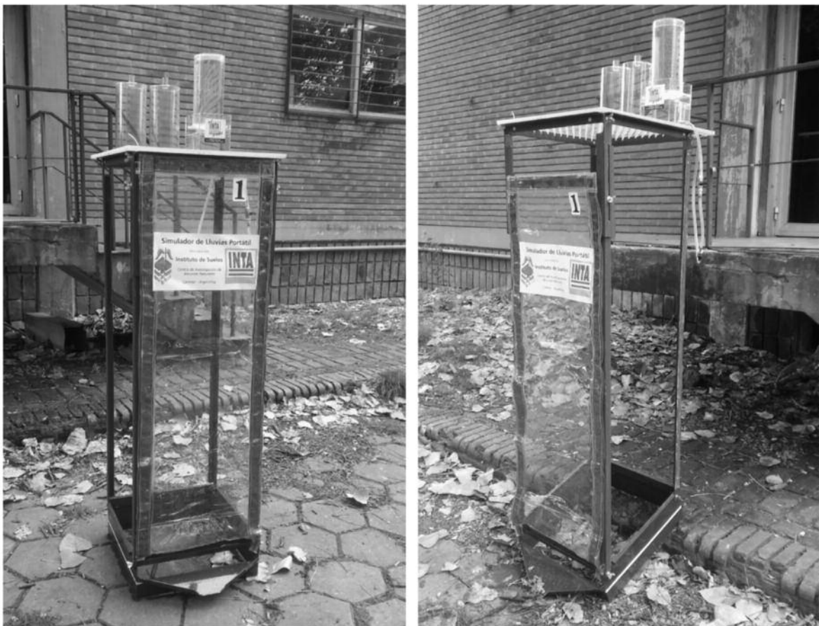
Figura 3. a: Micro-simulador de lluvias. b) Detalle del micro-simulador de lluvias mostrando una modificación para adaptarlo a terrenos con mucha pendiente.
